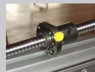
Vite a ricircolo di sfere: coppia elicoidale (E)
